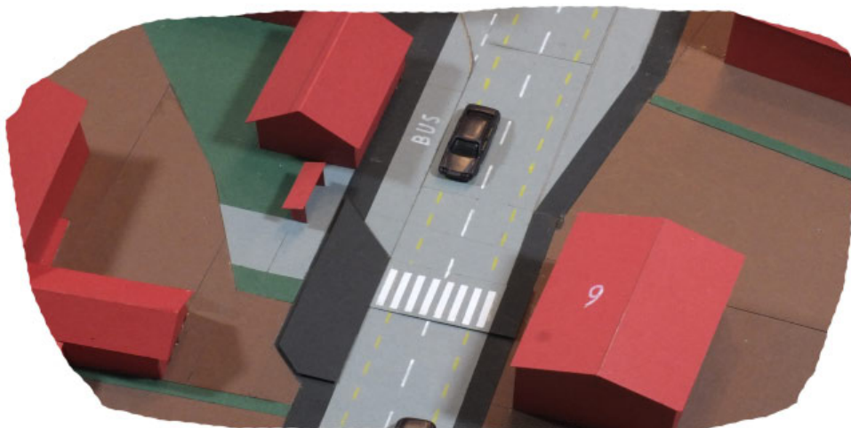
Bild 5: Anstelle der Ampelsicherung ist hier ein Fußgängerüberweg als „Zebrastrreifen“ realisiert.
