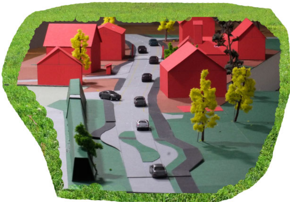
Bild 7: Der nördliche Ortseingang von Sperberslohe. Links ist der Lärmschutzwall zu erkennen.
